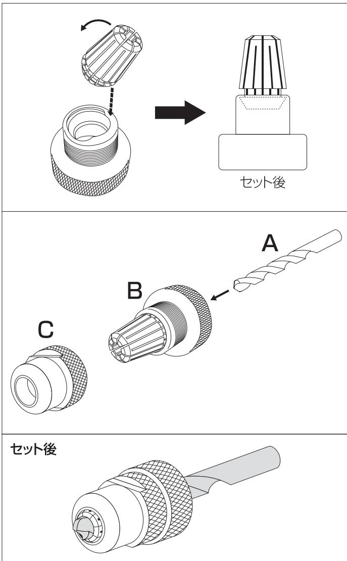
■例えば、7.1～8.0のコレットで $\phi$ 8.0のドリルを締め付ける場合には比較的楽に、 $\phi$ 7.1のドリルを締め付ける場合には締め付け量が多くなり、従って作業性も悪くなります。
