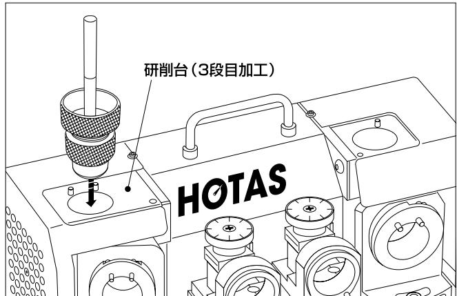
●先ず本体左側前面の研削台にて2段目を研磨します。先ほどのホルダーとドリルをセットし、円錐研磨加工が終了した状態でホルダーのスリーブを研削台に挿入します。研磨音が無くなるまで軽く押しながら研磨します。研磨音がなくなれば本体左側上面の研削台に挿入し3段目を研磨します。こちらも軽く力を加えながら研磨音が無くなるまで研磨します。
