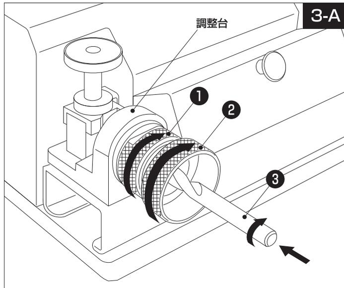
注意：この時必要以上の強い力で締め付けないようにしてください。調整台の故障やストッパーの磨耗の原因になります。
