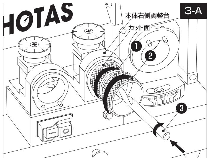
注意：この時必要以上の強い力で締め付けないようにしてください。調整台の故障やストップーの磨耗の原因になります。
