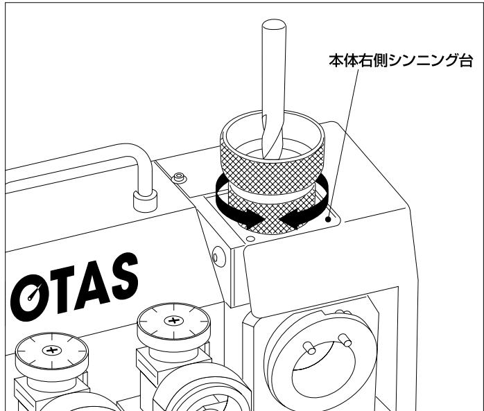
●シンニングの加工量は付属のシム(0.1mmと0.3mm)にて調整することができます。加工量を少なくしたい時には付属のシムをシンニング台に置いて調整して下さい。
