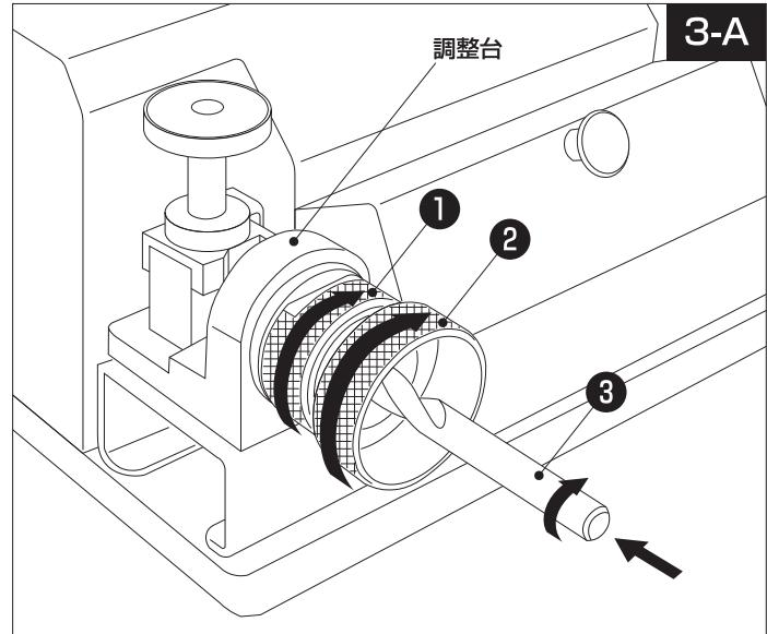
注意：この時必要以上の強い力で締め付けないようにしてください。調整台の故障やストップバーの磨耗の原因になります。
