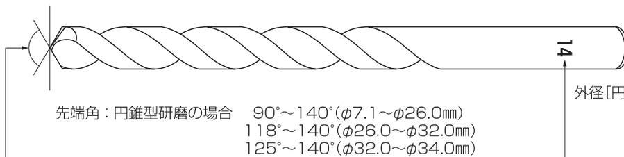
先端角：円錐型研磨の場合 90°~140°(φ7.1~φ26.0mm)
