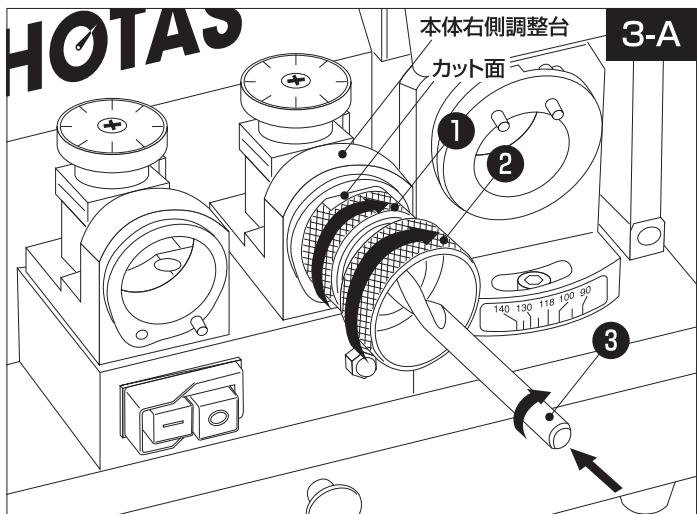
注意：この時必要以上の強い力で締め付けないようにしてください。調整台の故障やストッパーの磨耗の原因になります。
