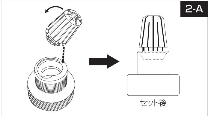
●締め付けナット【C】(雌ネジ側)にコレットを差し込むようにして、ホルダー【B】とネジで軽くつなぎます。
