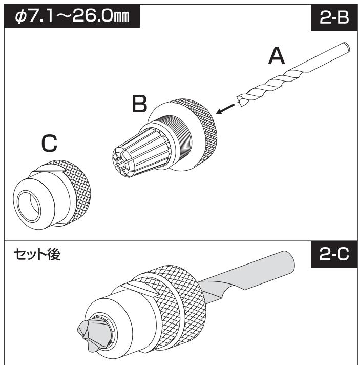
■PG-C-18のコレットで $\phi$ 18.0のドリルを締め付ける場合には比較的楽に締め付けることができます。逆に $\phi$ 17.1のドリルを締め付ける場合には締め付け量が多くなりますので、従って作業性も悪くなります。
