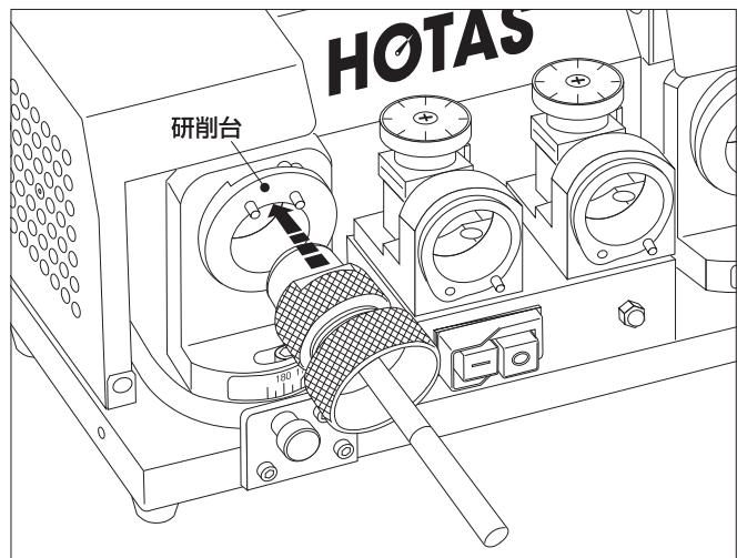
●先ず本体左側前面の研削台にて2段目を研磨します。
