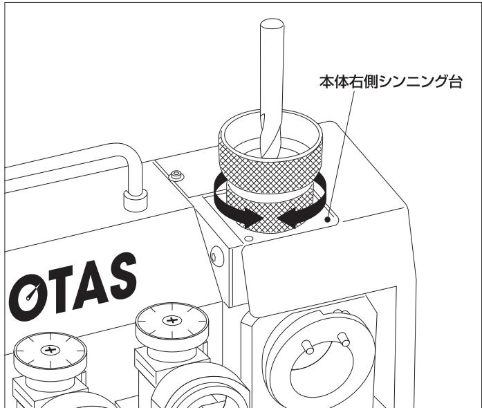
●シンニングの加工量は付属のシム(0.1mmと0.3mm)にて調整することができます。加工量を少なくしたい時には付属のシムをシンニング台に置いて調整してください。
