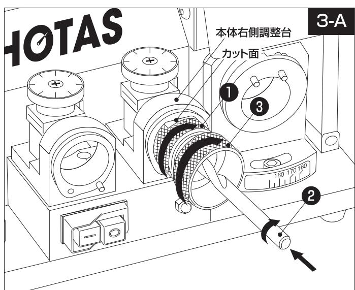
注意：この時必要以上の強い力で締め付けないようにしてください。調整台の故障やストップーの磨耗の原因になります。
