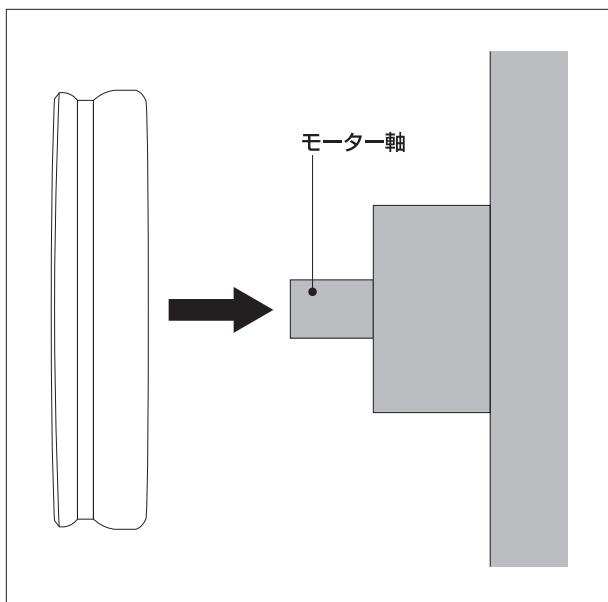
● $\phi 7.1\text{mm} \sim \phi 16.0\text{mm}$ のドリルを研磨する場合は下図のようにRの小さい方をモーター軸側へ取り付けてください。
