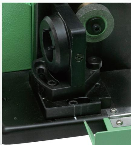
一般的なTIG溶接に用いられる電極棒の研磨機。
