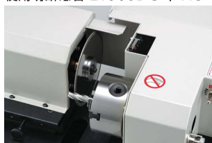
超硬エンドミルの切断 使用切断砥石 E100SDC φ115
