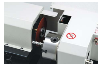
HSSエンドミルの切断 使用切断砥石 E60WA φ100
