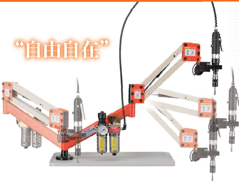
**HOTAS**のクイックタップで簡単に効率よく精度の高いタッピング作業ができます。
